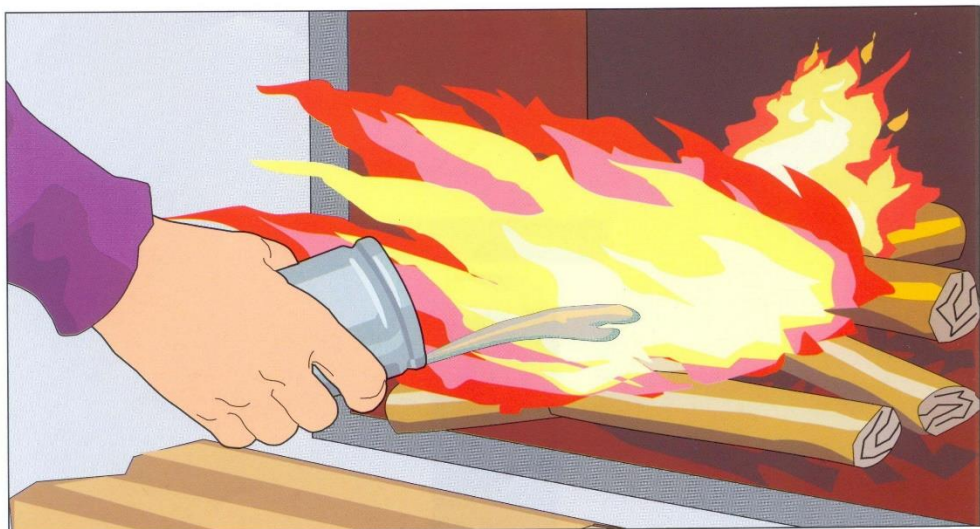
Применение для розжига печи легковоспламеняющихся и горючих жидкостей, выпадение углей, трещины в кладке, возгорание сажи в дымоходах
